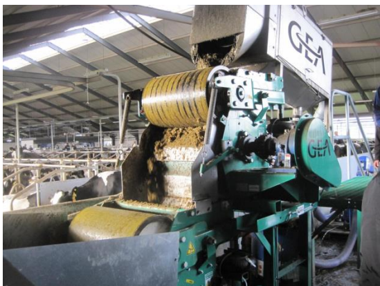
Bild 1: Valsverk som separerar fiberfraktionen ur kogödsel
