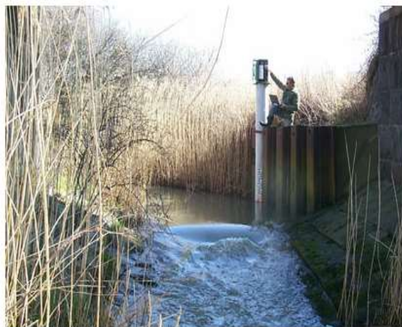
Vattenföringsmätning i en jordbrukså i Halland. Foto: Katarina Kyllmar, SLU.
