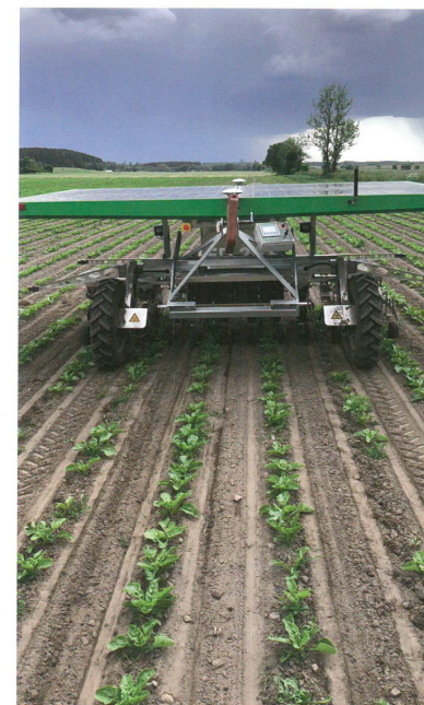
En hektar per timme. Kapaciteten är cirka en hektar per timme både när maskinen sår betor och ogränsar dem.
