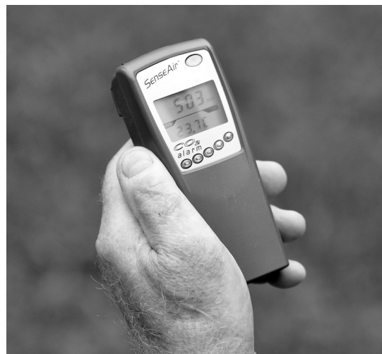
Figur ?? Exempel på handhållet instrument för mätning av koldioxidhalten i luft.
