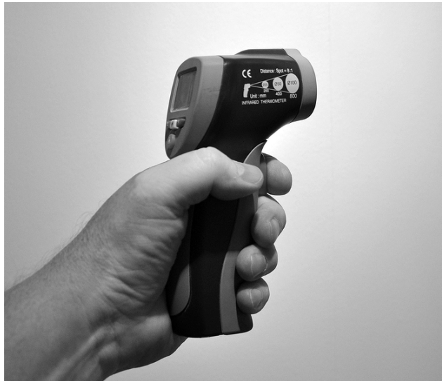
Figur ?? Exempel på en enkel, beröringsfri IR-termometer
