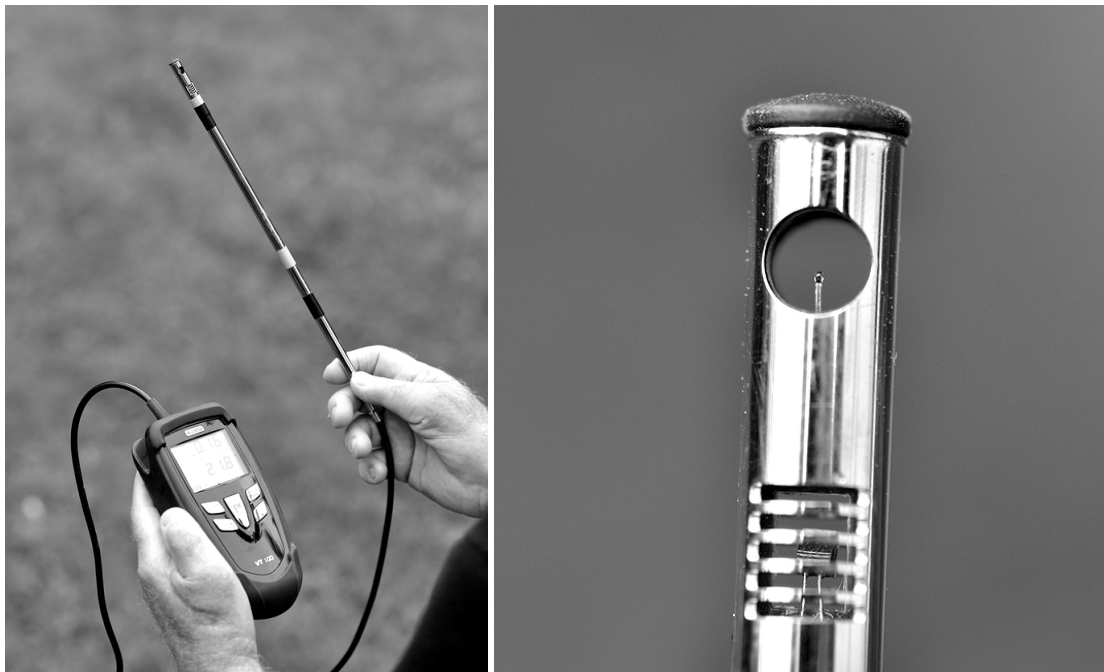
Figur ?? Exempel på termoanemometer. Den minimala känselkroppen sitter i änden på staven.
