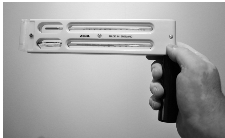
Figur ?? Slungpsykrometer som mäter torr och "våt" temperatur. Dessa två värden ger den relativa luftfuktigheten med god noggrannhet.
