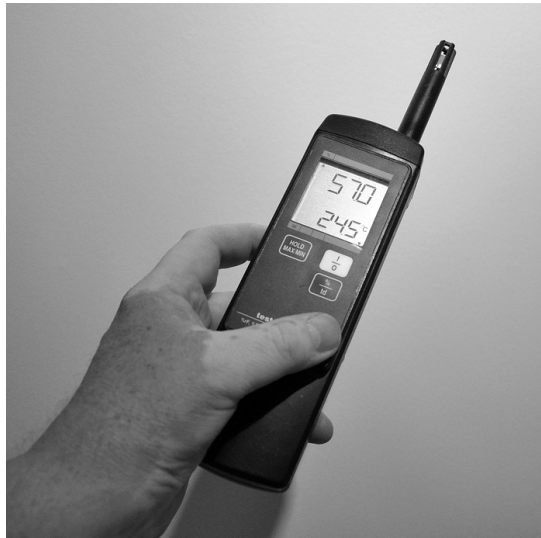
Figur ?? Exempel på elektroniskt instrument för mätning av luftfuktighet och temperatur.
