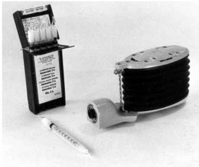
Figur ?? Exempel på utrustning för mätning av gaskoncentrationer i luft - handpump och reagensrör.
