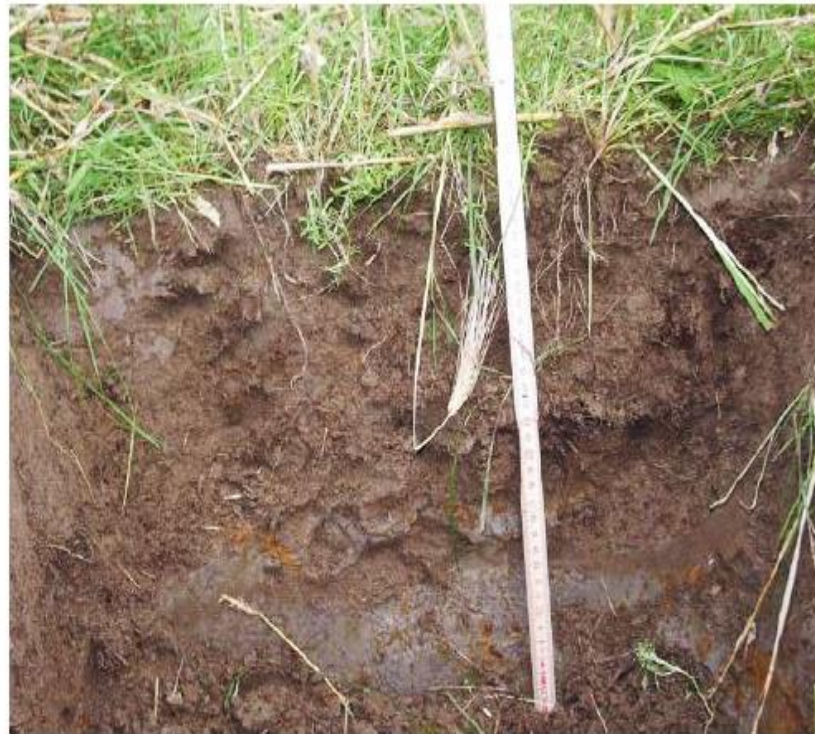
Bild 4. Ruta 49 led G, glyfosat (Roundup) Röbbäcksdalen 2008. Ett tydligt skikt av onedbruten förna syns på plogdjup.
