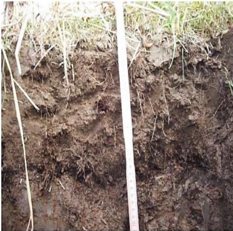
Bild 1. Ruta 44 led E, tallriksredskap 1 körning Röbäcksdalen 2008. I ett skikt på plöjningsdjup, c:a 20 cm, syns rikligt med onedbrutna rester av förna.
