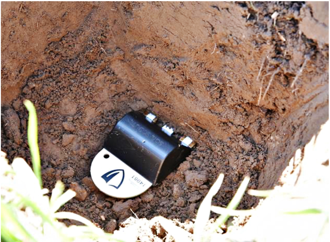
Figur 3.1. Trådlösa givare som installeras i jorden för flera år för att mäta markens fuktighet kan monteras parvis i olika skikt av jorden. Givarna kan också ge data om markens salinitet och temperatur. (Bild: Markku Pulkkinen.)
