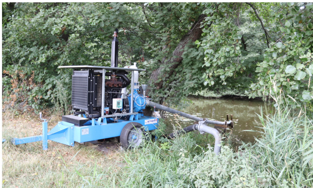
Figur 7.1. Pump med förbränningsmotor som används för att pumpa vatten från ån för bevattning. Pickala gård, Sjundea (Bild: Jani Bergholm.)
