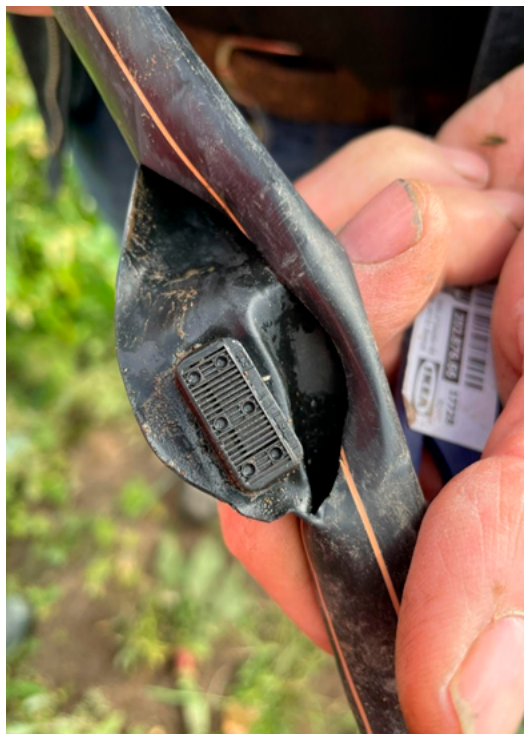
Figur 6.5. En fuktbevattningsslang fotograferad vid perforeringen, från slangens ut- och insida. För att förhindra att hålen täpps är det viktigt att bevattningsvattnet filtreras tillräckligt bra. Flödesutjämnarens syfte är att utjämna flödet till perforeringarna för att bevattningen ska vara så jämn som möjligt trots att trycket i röret varierar. (Bild: Lantbrukarnas Riksförbund (LRF).)
