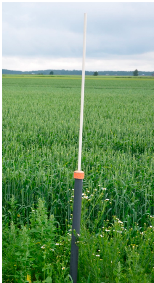
Figur 6.4. Grundvattennivån kan mätas med en antenn försedd med en flottör som placeras i grundvattenröret och som visar avståndet mellan grundvattennivån och markytan. Det finns också automatiska mätare för mätning av grundvattennivån. (Bild: Rainer Rosendahl)
