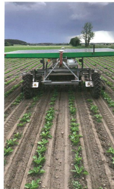
En hektar per timme. Kapaciteten är cirka en hektar per timme både när maskinen sår betor och ogrärensar dem.
