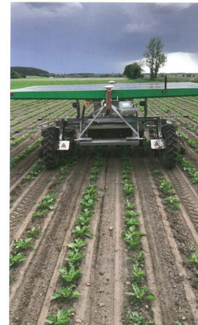
En hektar per timme. Kapaciteten är cirka en hektar per timme både när maskinen sår betor och ogränsår dem.
